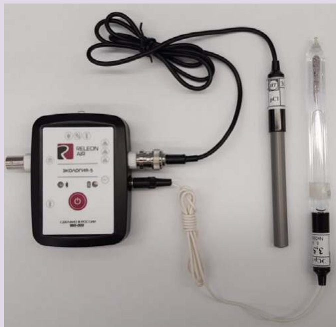
Рис. 10. Ионоселективный датчик (присоединены электро хлорид-ионов и электрод сравнения)
